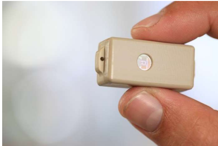
Bild 1: Prototyp des im Projekt „IntelliTUM“ entwickelten Implantates. Wird das System ohne O 2 -Erzeugungseinheit eingesetzt, reduziert sich die Größe des Implantats auf ein Viertel.
