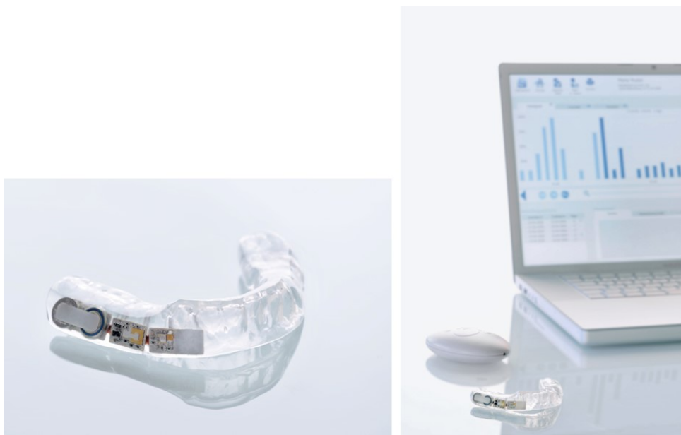
Bild 1: Die intelligente Zahnschiene als Erprobungsträger der Technologieplattform für intelligente Implantate und zur Detektion und Therapie von Bruxismus.
