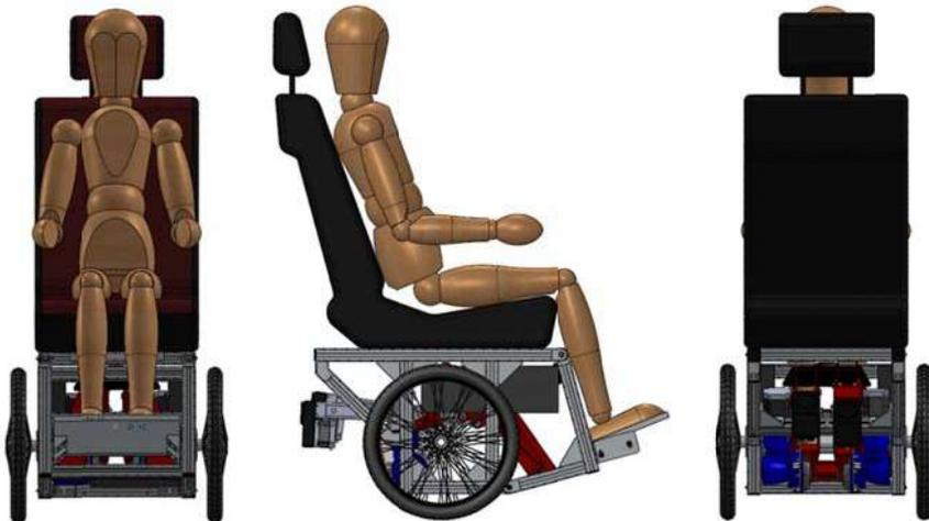
*Abb. 1: AssistMobil-Sitz auf dem Rollstuhl-Fahrwerk in verschiedenen Ansichten (Schemazeichnung)*
