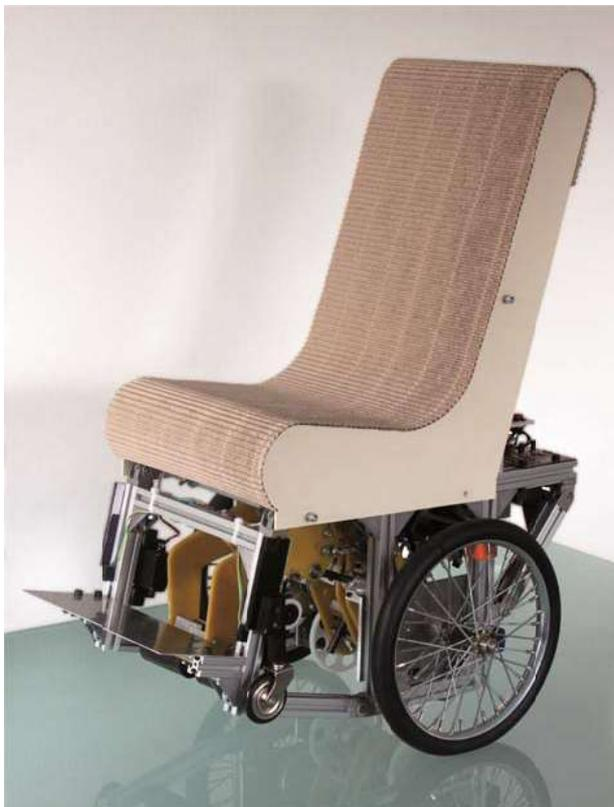
*Abb. 2: AssistMobil-Rollstuhl als Technologie-Demonstrator im Maßstab 1:2*
